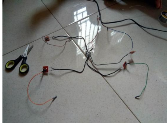
Gambar 7. Proses penyambungan kabel dengan sensor cahaya menggunakan solder.
